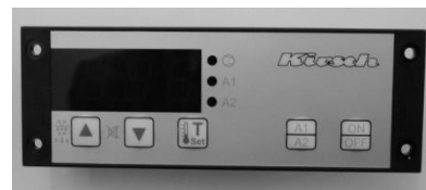
Frontansicht digitale Temperaturanzeige
